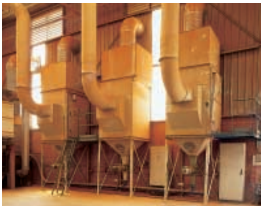
Récupération des poussières de rectification des briques
